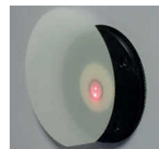
蓝宝石样品：因透明性可观测到两束光的位置
