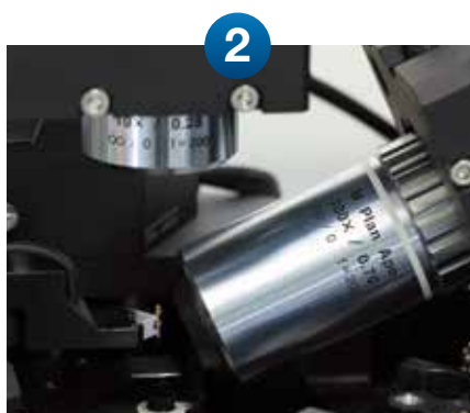
顶部和侧向配 100 \times 高数值孔径物镜，提高灵敏度和空间分辨率
